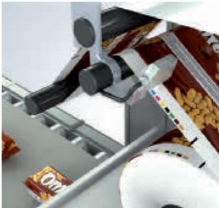
Detecção fiável de marcas standard ou semi-transparentes a velocidade normal ou elevada
